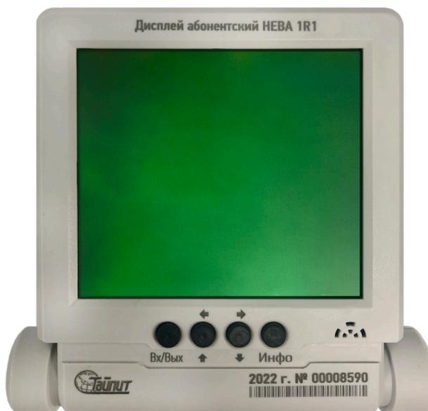
Рис. 4.1 - Внешний вид дисплея (пульта) для прибора учета электрической энергии марки НЕВА
