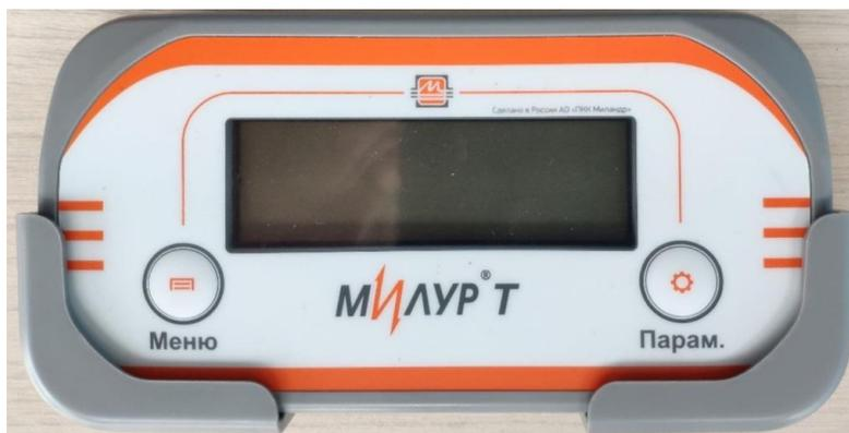
Рис. 5.1 - Внешний вид дисплея (пульта) для прибора учета электрической энергии марки Милур Т
