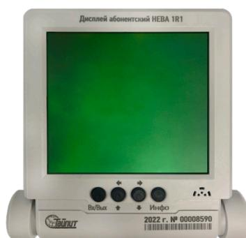
Рис. 4.9 - Внешний вид дисплея (пульта) для прибора учета электрической энергии марки НЕВА
