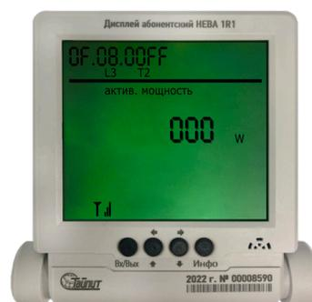
Рис. 4.8 – Активная мощность. Текущие показания счетчика
