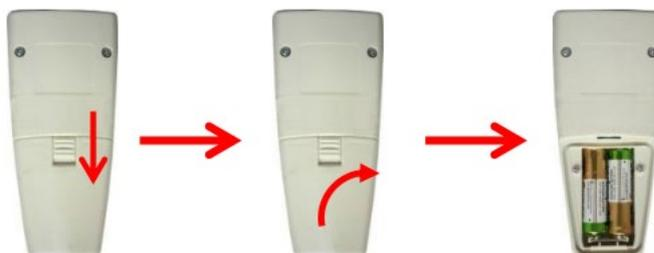
Рис. 6.2 – Установка элементов питания
